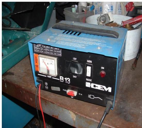
**Fig. 21 – carica batteria portatile**
