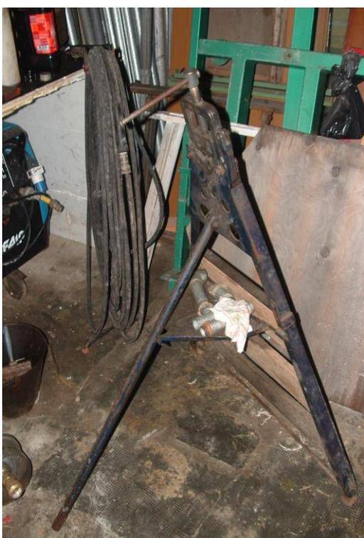
**Fig. 29 – cavalletto, morsa per idraulico**
