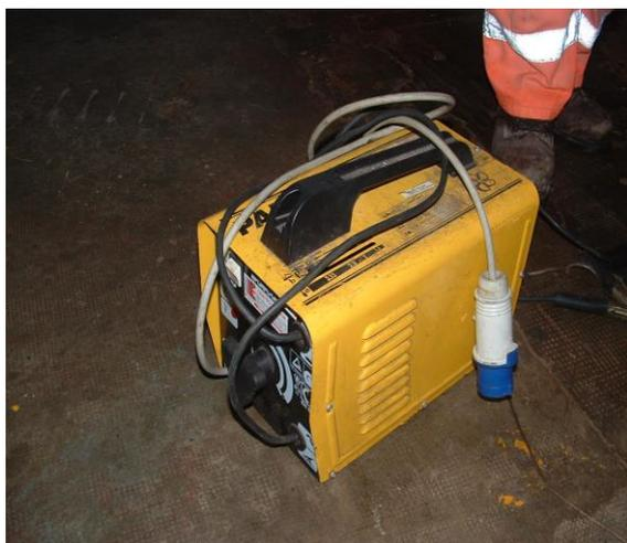
**Fig. 16 – saldatrice elettrica**
